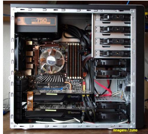
Figura 4.2: Gabinete de 4 baias.
